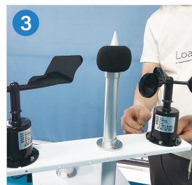
将风速/风向/噪声安装在支架上 风向底面S标识朝南安装
