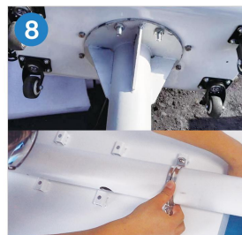
用4颗螺丝钉把箱子固定到 立杆上 用3个卡箍6颗螺丝钉把LED 固定到立杆上
