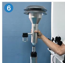
将切割器装在加热管顶端
